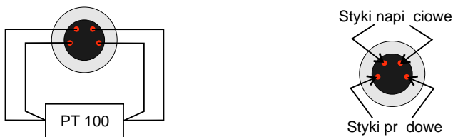
Rys.14 Układ styków złącza czujnika temperatury
